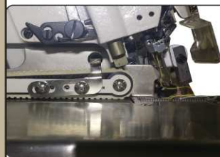
오바, 인터용 감속기 (롤러 폭 : 10mm/m) FOR INTER & OVERLOCK
