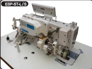
본봉용 감속기 (롤러 폭 : 12, 18, 30, 50mm) FOR 1-NEEDLE
