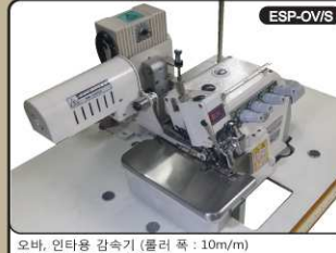
오바, 인터용 감속기 (롤러 폭 : 10mm/m) FOR INTER & OVERLOCK
