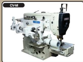
상봉용 감속기 (롤러 폭 : 上 50mm, 下 60mm) 선택사항 : 上, 下 PVC롤러 / 上 우레탄, 下 스틸 FOR COVERSTITCH
